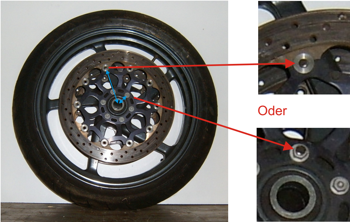
Der Abstand von Magnet zu Achse spielt keine Rolle
